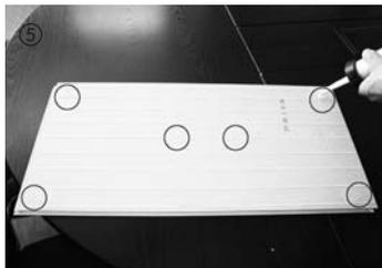
Den Kartuschenkleber in eine handelsübliche Kartuschenpistole einlegen und Klebstoff wie auf dem Bild gezeigt auftragen. Der Auftrag des Klebstoffes muß jeweils direkt vor dem Verlegen erfolgen.
